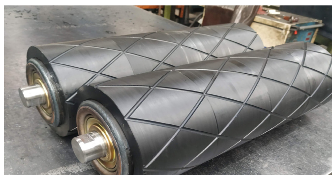
Revestimiento de HDPE
