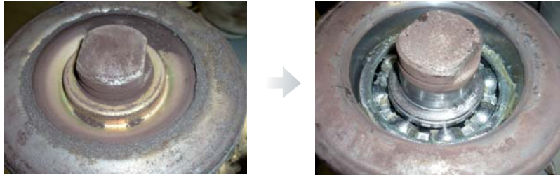
Resultados de una prueba de resistencia a polvo.
